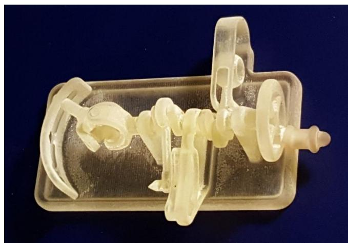
Slika 3.9: Prototip, izdelan na podlagi računalniške skice s 3D-tiskalnikom (Vir: foto avtor B.Likar)
